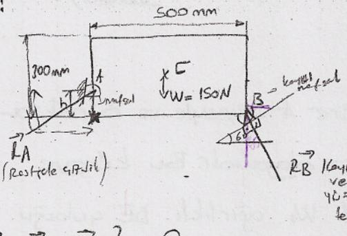
Şekildeki levhanın dengede olabilmesi için A ve B reaksiyon kuvvetlerini belirteyiniz?
