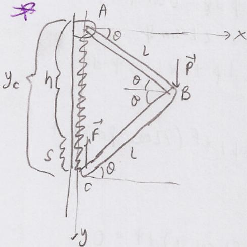
Mekanizmanın denge konumuna karşılık olan Q acısı ve yaydaki çekme kuvveti için bağıntıları bulunuz. Yayın şekil değiştirmemiş uzunluğu h ve yay kats. k'dır. Mekanizmanın ağırlığını ihmal edebilirsiniz.
