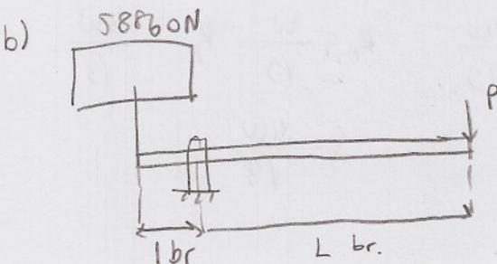
b) Aynı P kuvvetini kullanarak kamyonu dengede tutmak için gerekli L'yi bulun.
