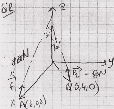
ÖR: O noktasındaki vektör sisteminin indirgenmiş elementleri bulunur.
