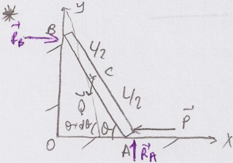
Ağırlığı  $\vec{Q}$  ve uzunluęu  $l$  olan AB çubuęu dięey düzlem içinde bulunmakta ve A ile B uçları cilalı yüzeyler tarafından mesnetlenmektedir. Çubuęun yatayla yaptıęı açı  $\theta$  iken dengede olabilmesi için A'ya uygulanmalı gereken yatay  $\vec{P}$  kuvveti nedir?
