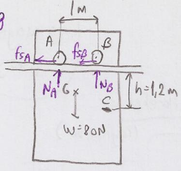
Ağırlığı 80 N olan, bir sürgü kapı, şekildaki gibi yatay bir yaya A ve B noktalarından asılmıştır. Yay ile kapı arasındaki  $\mu_A = 0,2$   $\mu_B = 0,3$  ise kapıyı sağa doğru hareket ettirmek için C noktasına uygulanması gereken yatay P kuvveti ne kadar olmalıdır?
