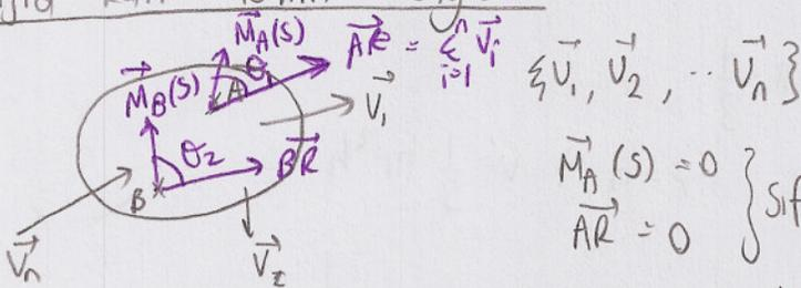
$$\left. \begin{aligned} \vec{M}_A(s) &= 0 \\ \vec{A}\vec{R} &= 0 \end{aligned} \right\} \text{Sıfıra eşdeğer vektör sist.}$$
