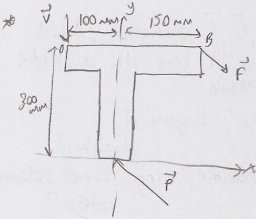
Şekildeki cisim kuvvetler etkisindeyken orijindeki indirgene el? Sistem dengede mi?
