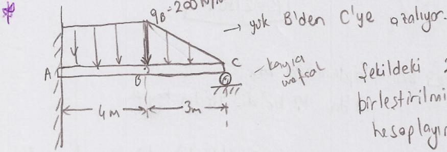
Şekildeki 2 parçadan oluşan, B'de pim ile birleştirilmiş sisteme, A ve C'deki tepkileri hesaplayınız.
