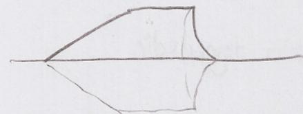
2) Düzlemsel bir yüzey parçasının kendi düzlemi içinde bulunan ve kendini kesmeyen bir eksen etrafında döndürülmesiyle meydana gelen dönel cismin hacmi, yüzey parçasının alanı ile yüzey parçası ağırlık merkezinin bu dönmede çizdiği (çember veya çember yayı) yörüngenin uzunluğu çarpımına eşittir.
