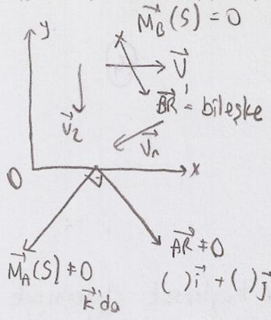
Bir vektör sistemi bir noktada sadece geometrik toplam ile ifade edilebiliyorsa, sistem o noktada bileşke veriyor demiz. Aynı sistem diğer noktalarda incelendiğinde birbirine dik 2 indirgenmiş elemanına sahiptir. Bileş. sistemi tek başına ifade eder. Geometrik toplamla karıştırılmamalıdır.
