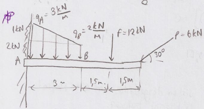
Şekildeki kirişin A noktasından 3m. uzaklıkta oluşan kesme kuvveti ve eğilme momenti değerlerini bulunuz.
