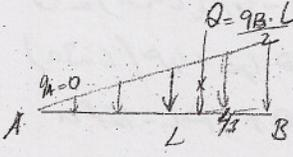
Bir cismin yüzeyinin her maddesel noktasına uygulanmış ağırlıklar (baraj duvarının yüzeyine gelen su basıncı, bir kırımın ağırlığı gibi) yayılı kuvvetlere hesaplanır ve daha yük diagramıyla gösterilirler. Yük diagramında yayılı yükün kesit yüzey alanının ölçüsü bileşkenin cebirsel ölçüsünü verir. Ve böylece aynı sınırlı yüzeyin  $\theta$  ağırlık merkezinin düzeyinden geçer.
