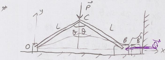
Şekilde verilen sistemde mafsallar ve B bloğunun yatayla temasının sürtünmesi kabul edilerek C'den dikey P kuvveti uygulandığında verilen konumda B bloğunun sıkıştıracağı cisme uyguladığı yatay Q kuvvetini hesaplayınız.
