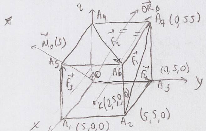
5x5x5'lik bir küpe F<sub>1</sub>, F<sub>2</sub>, F<sub>3</sub>, F<sub>4</sub> etki ediyor. Bu kuvvet sisteminin orjindeki indirgenme elemanlarını, sistemin invarianlarını bulunuz. Dejenerelik şartını inceleyiniz. Merkezi eksen bir bileşkeye eşdeğer ise tesis doğrusunu belirleyin.
