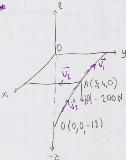
Verilen vektör sisteminin 0'a eşdeğer olabilmesi için  $\vec{U}_1, \vec{U}_2, \vec{U}_3$ 'ün modülleri.
