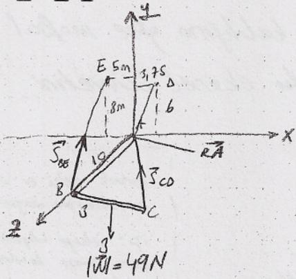
Ağırlığı ihmal edilen ABC çubuğu xoz düzlemine A'da küresel mafsalla mesnetlenmiş ve BE ile CD kablolarıyla bağlanmıştır. A'daki mafsal tepkisini ve kablolardaki kuvvetleri bulunuz.
