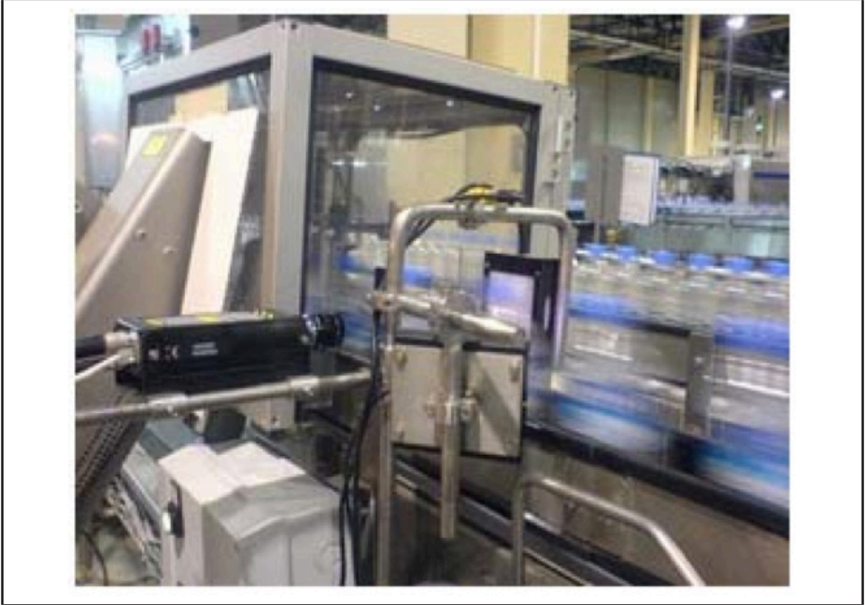
Şekil-2.3: Pet Şişe Su Fabrikasında Poka-Yoke Uygulama Örneği
