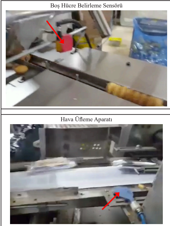
Şekil-3.67: Boş Hücre Belirleme Sensörü ve Hava Üfleme Aparatı
